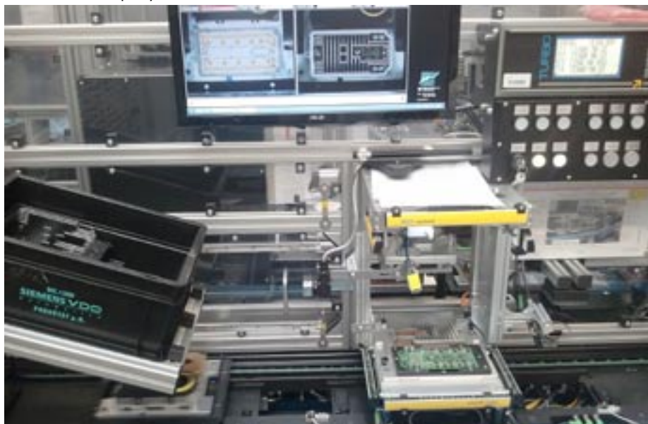
Zařazení systému vizuální inspekce do automatizované výrobní linky
