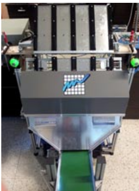
Automat se zakrytými snímacími hlavami a výstupním pásovým dopravníkem
