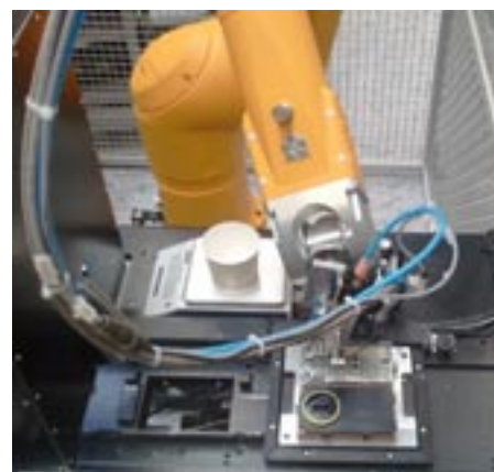
Nanášení pasty robotem
