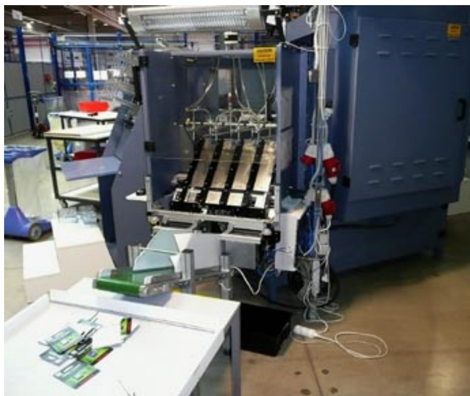
Automat se zakrytými snímacími hlavami a výstupním pásovým dopravníkem
