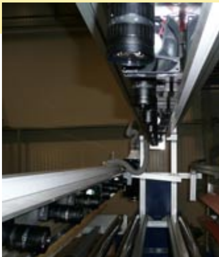
Výrobek je sledován šestnácti kamerami na dvou rámech po osmi
