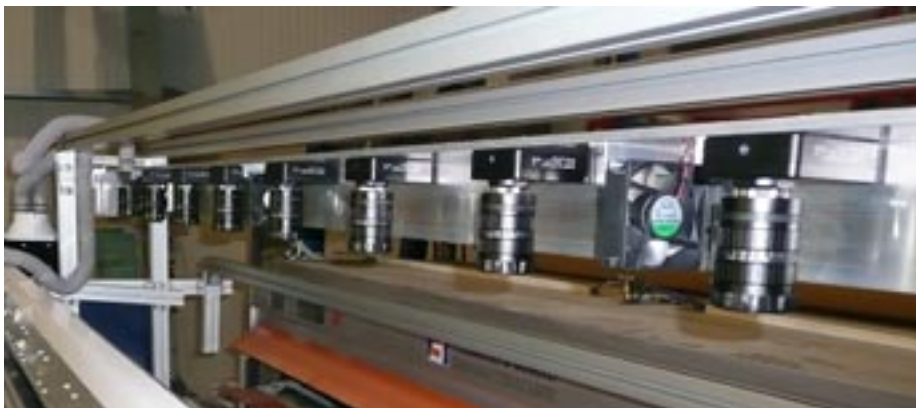
Výrobek je sledován šestnácti kamerami na dvou rámech po osmi
