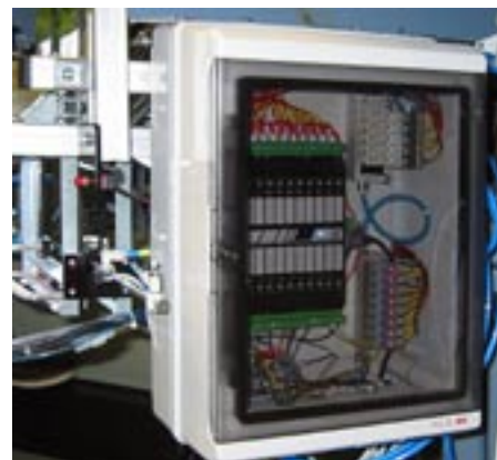
Veškeré pneumatiké akční členy jsou řízeny prostřednictvím jednotky DataLab IO
